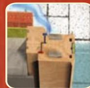
**3-fach-Dichtungs-Konzept mit einer Doppeldichtung im Haustürfalz sorgt neben einer zusätzlichen Dichtung im Blendrahmen für einen Zug- und Kältestopp**
