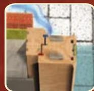
Dichtungs-Konzept mit Doppeldichtung (1 x im Blendrahmen, 1 x im Türflügel)
